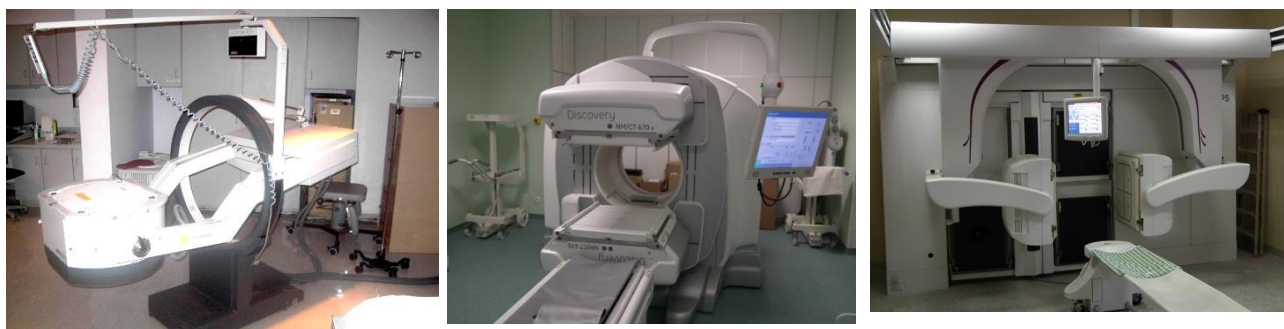
Rys. 1. Różne typy gamma kamer, od lewej: Apex SPX-4 (Elsint), Discovery NM/CT 670 (GE), Skylite (Philips).
