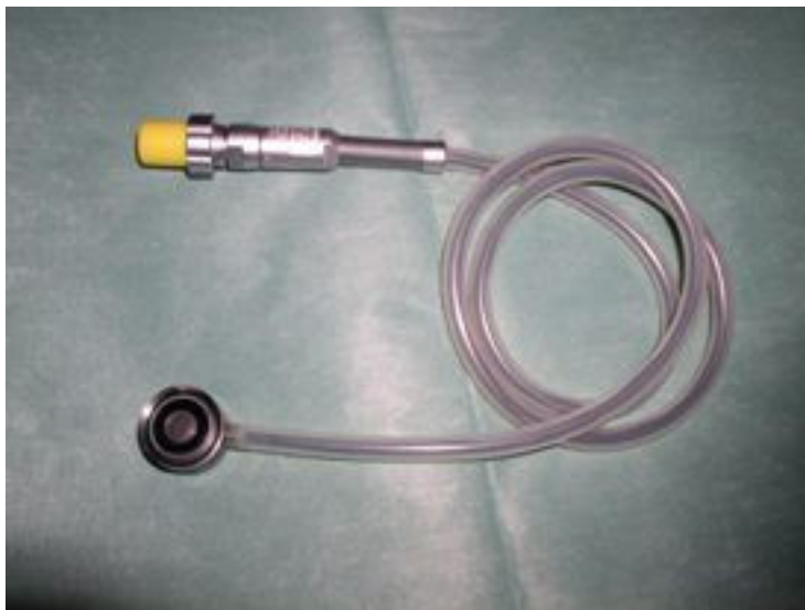
Ryc. 7. Komora płaska Markus typ 23343 firmy PTW.
