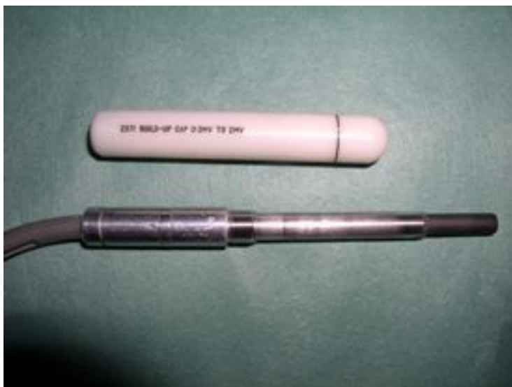
Ryc. 4. Komora cylindryczna typu Farmer, typ 30013 firmy PTW.
