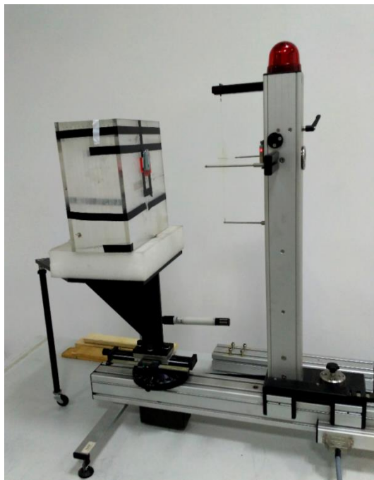
Rysunek 9. Stanowisko pomiarowe Beta Secondary Standard 2 [4]
