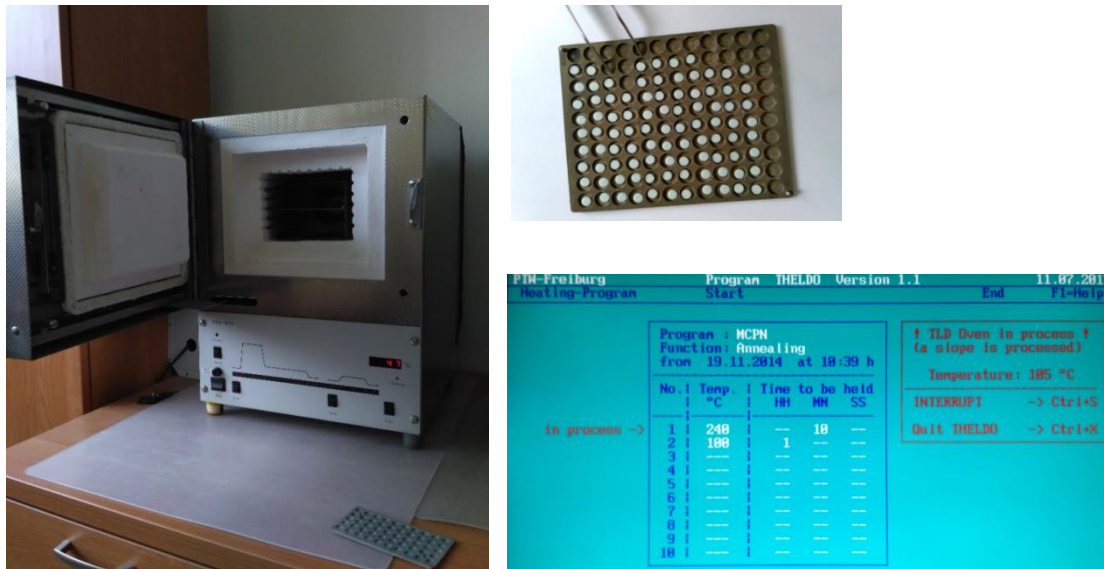
Rysunek 3. Piec TLDO, metalowa szalka na pastylki i screen oprogramowania sterującego piecem [4]
