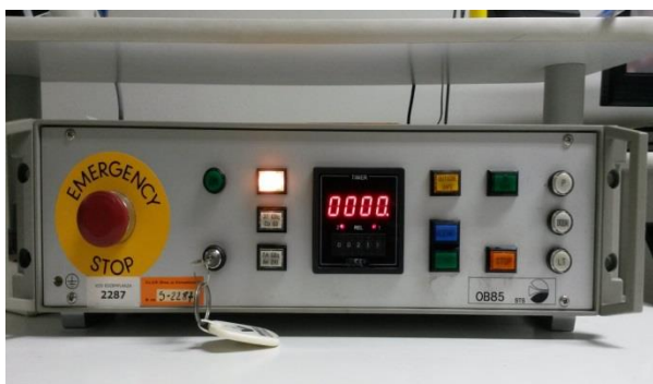
Rysunek 7. Elementy stanowiska kalibracyjnego Gamma: panel sterujący i iradiator z ławą [4]
