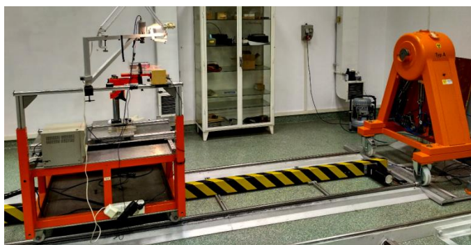
Rysunek 7. Elementy stanowiska kalibracyjnego Gamma: panel sterujący i iradiator z ławą [4]
