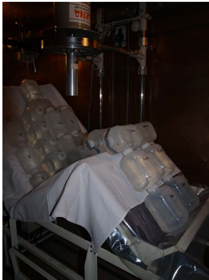
Rys 2. Kalibracja wydajnościowa licznika promieniowania całego ciała za pomocą fantomu butelkowego.
